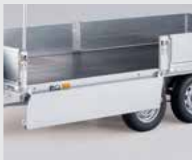
Ridelles en acier Ridelles latérales, avant et arrière amovibles.
