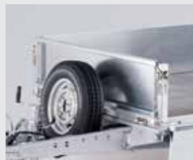
Ridelle avant en acier Ridelle avant amovible, très utile pour les longs chargements.
